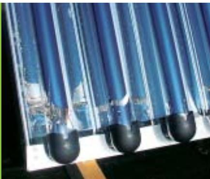
**GLASBRUCH** Glasbruch an Vakuumröhren (links), verursacht durch kalte Solarflüssigkeit, die im Temperaturschock-Härtetest durch die heißen Röhren strömte. Da dies – wenn überhaupt – eher bei Inbetriebnahme vorkommt und dann ein Garantiefall ist, haben wir die Urteile nur milde abgewertet. **AUFDACHMONTAGE** Bei ihr sitzen die Halterungen auf den Sparren (rechts). Bei der Indachmontage lassen sich Dachziegel sparen.
